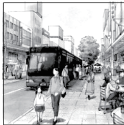
歩車共存道路 Transit mall 歩行者天国の中に公共交通のみ通行可能とする道路。日本での導入事例は沖縄県那覇市国際通（毎週日曜）
